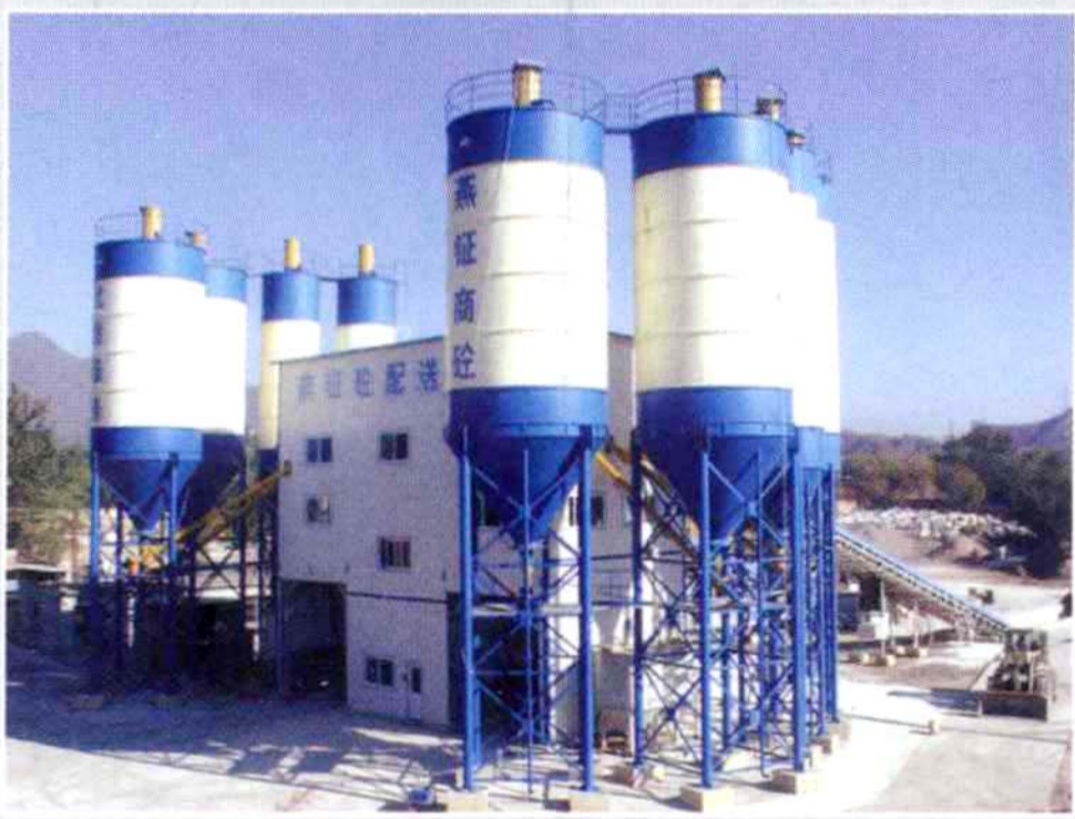
商品混凝土搅拌站
