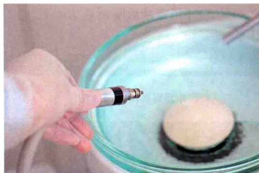
图 1-3-2 冲洗供水管路
