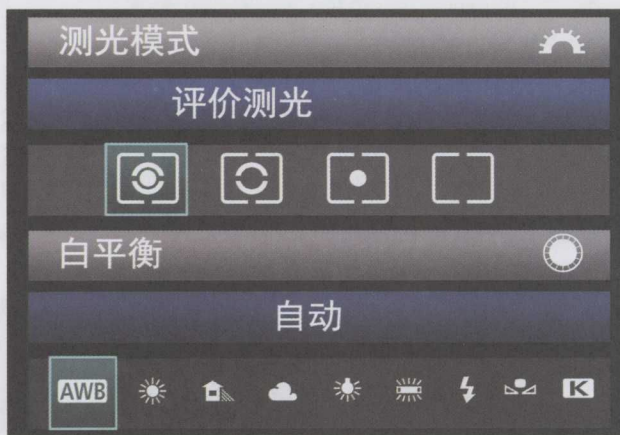
图1-4 测光模式 (从上往下数第三行, 从左到右): 评价测光、局部测光、点测光和中央重点平均测光。
