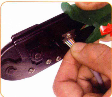
修整8根铜芯，将铜芯插入水晶头
