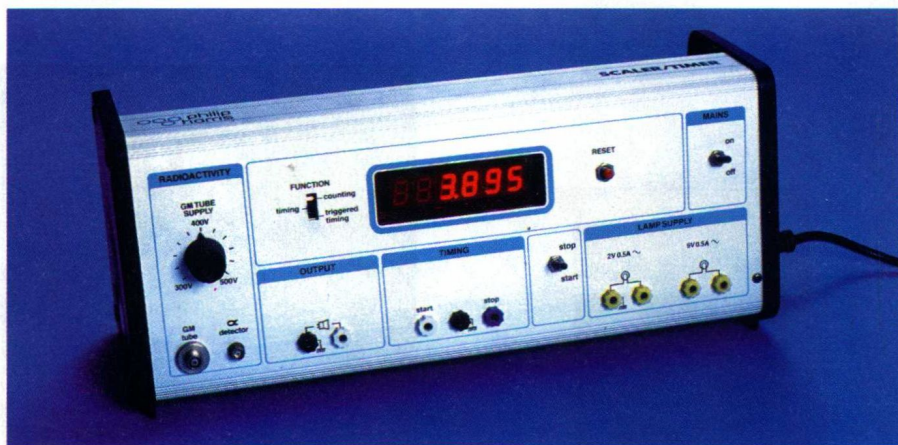
圖 9.1d 計時—計數器：精確度達千分之一秒
