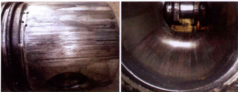
图 1-2 活塞和气缸拉伤（拉缸）
