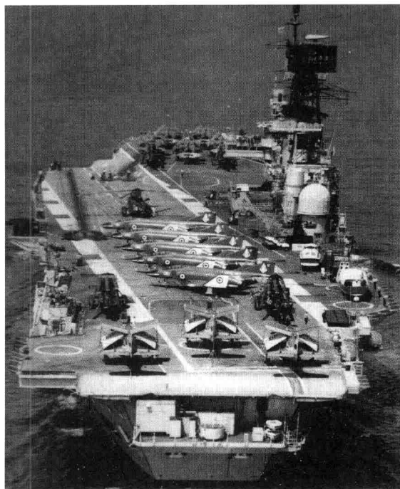
▲ 安装了斜角甲板之后的英国“大胆”级航空母舰“皇家方舟”号。进入喷气时代之后，斜角甲板也成为了大型航母的必备选择。
