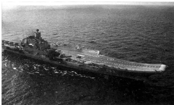
▲ 同时采用了斜角甲板和滑跃甲板的“库兹涅佐夫”级航空母舰，这也是迄今为止世界上仅有一级混合采用了两种甲板方案的航空母舰。
