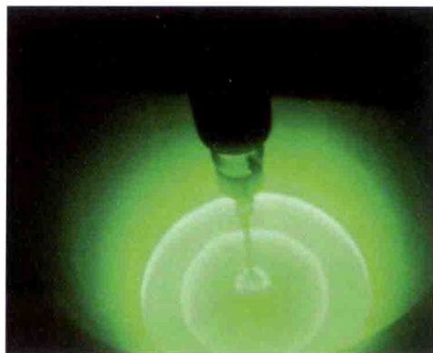
图6.12 单晶硅生长引晶过程： 籽晶前端与硅熔体接触，籽晶杆逆时针旋转，坩埚顺时针旋转
