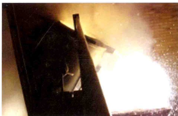
图4.3 精炼中硅水注入精炼炉示意图
