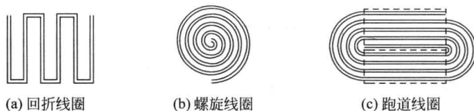
图 1-1 EMAT 的线圈结构
