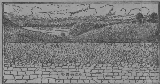
第一三九圖 這圖示明土壤以及土壤的下層是些甚麼。在頂上的是泥土；泥土的下面，就有半腐蝕的岩石；再下去就有堅固的岩石。這最下層的岩石中，也有許多裂縫。水液流進裂縫中，結成冰時，能把這岩石分裂開來。岩石常在那裏腐蝕成土壤。
