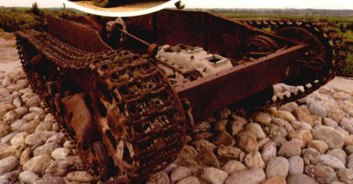
动机的动力通过一根很长的传动轴传至车体前部的变速箱，再由差速器或侧传动器传至主动轮，带动履带转动，推动坦克前进；主动轮在前，诱导轮在后。
