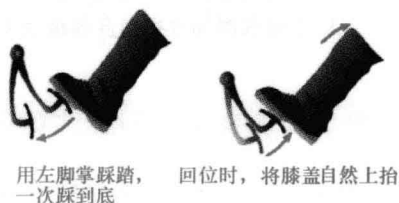
图1-2-3 离合器踏板操作示意图
