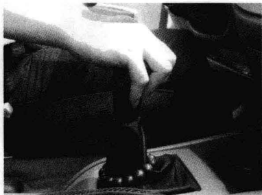
图 1-1-2 变速杆握法示意图
