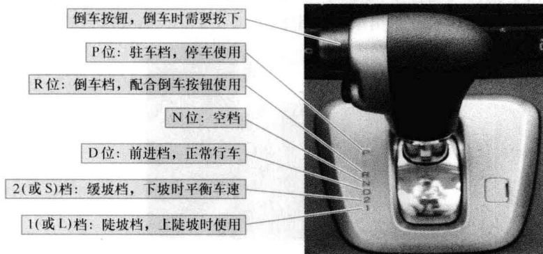
图 1-1-3 自动变速器档位示意图
