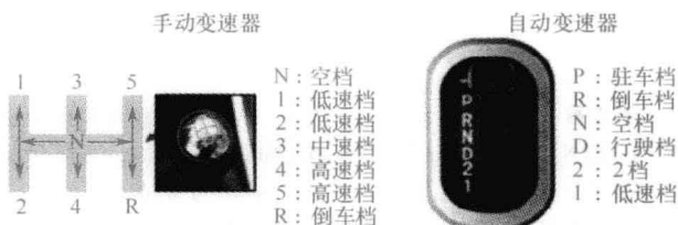
图 1-1-1 变速器档位布置图
