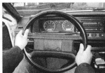
图 1-4-3 方向盘的握法示意图
