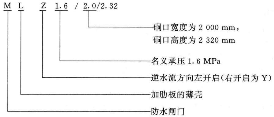
注: 按 MT154 标准, 将 LM 型薄壳防水闸门命名为 ML 型薄型壳防水闸门。
