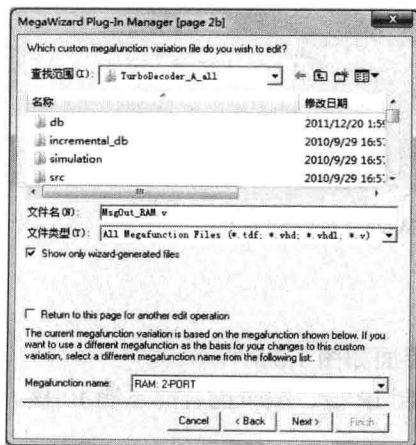
图 1.2.7 编辑已有 IP 核的 MegaWizard 插件管理器界面
