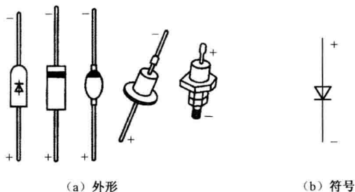
图 1-2 半导体二极管的外形与符号
