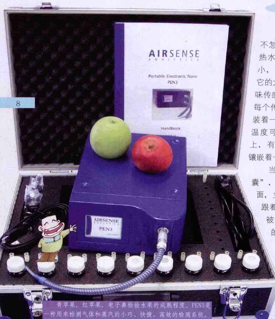
青苹果、红苹果，电子鼻检验水果的成熟程度。PEN3是一种用来检测气体和蒸汽的小巧、快捷、高效的检测系统。
