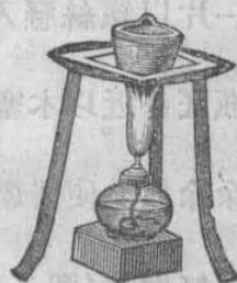
實驗 2 取洋燈罩或徑寸餘之玻璃筒一個中間嵌鐵絲布 Wire gauze 其上部滿盛輕養化鈉 Sodium hydroxide 之小塊而懸之於天平 Balance 上。其下置蠟燭使燃燒後所生之氣體為輕養化鈉所吸收。則見蠟燭漸滅。而此一端之重量反漸增。(圖 2)
