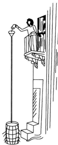
图 0-2 帕斯卡裂桶实验
