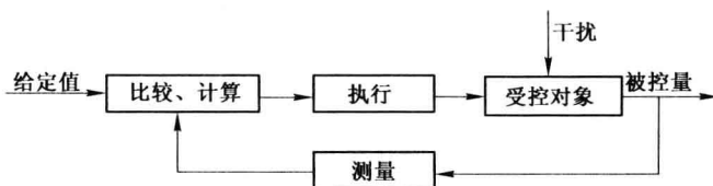
图 1-6 按偏差调节的系统原理方框图
