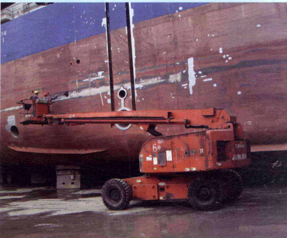
船体外板检测作业
