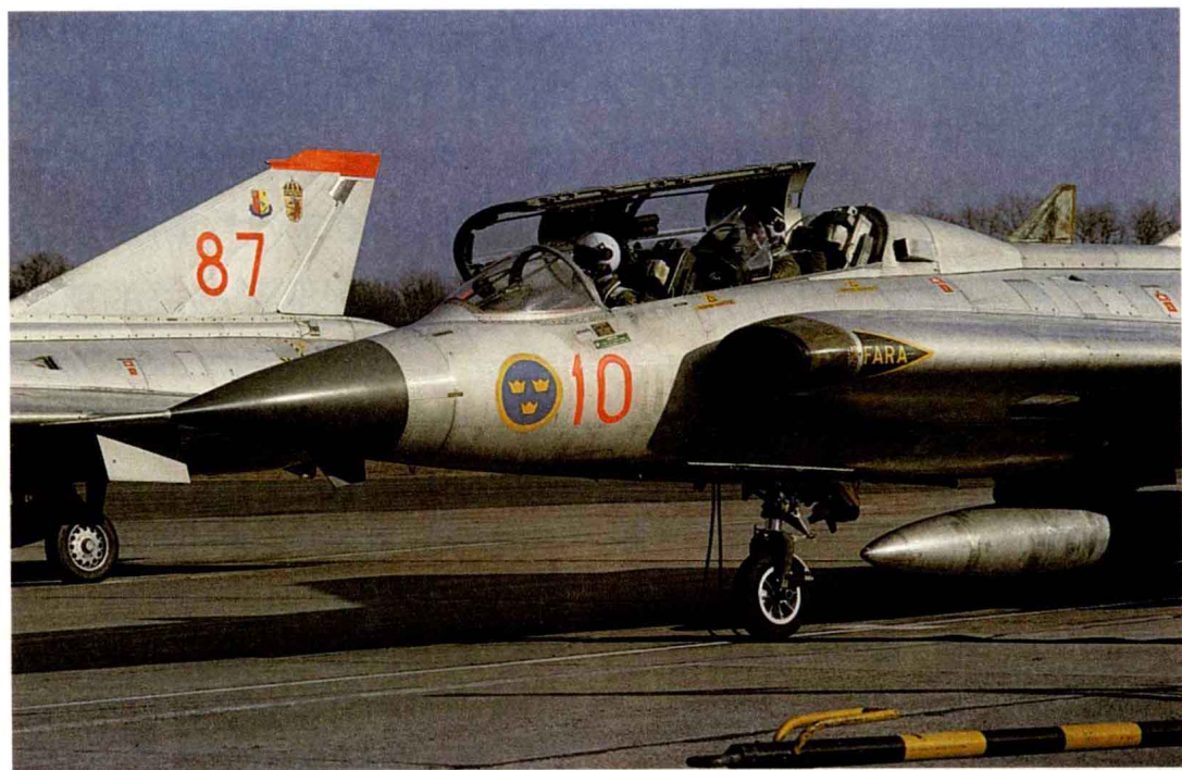
下图：双座教练机SK35C的开发工作早期便已展开。第二驾驶舱的空间通过减小前置燃料电池的大小来提供。
