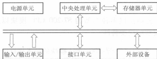
图 1-1 可编程序控制器的组成
