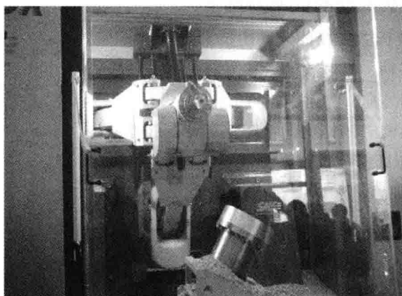
图 1-13 主轴和工件轴复合摆动型数控机床
