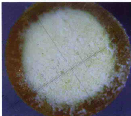
图 5-43 两步法制备的分层微孔药的切片显微观察图
