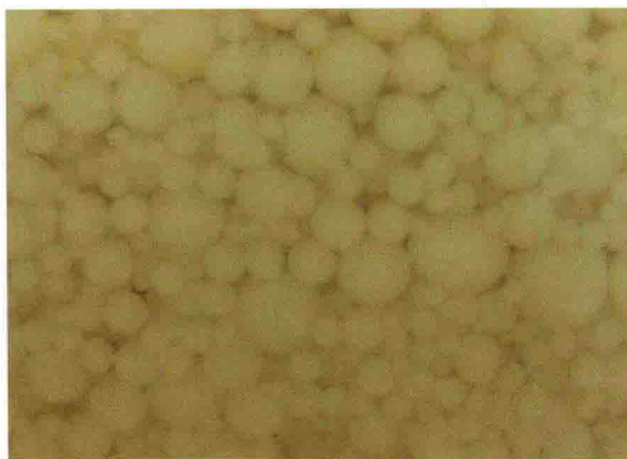
图 5-4 成球阶段有机相物料的分散状态
