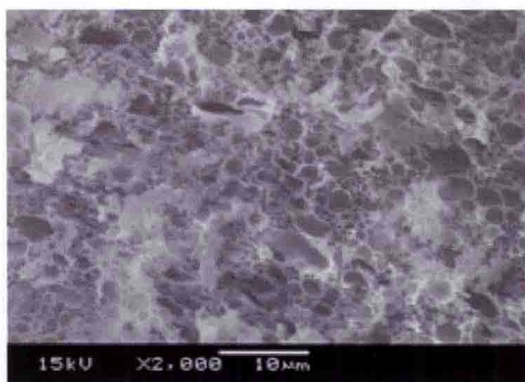
图 5-15 孔隙分布均匀的药粒切片的 SEM 图
