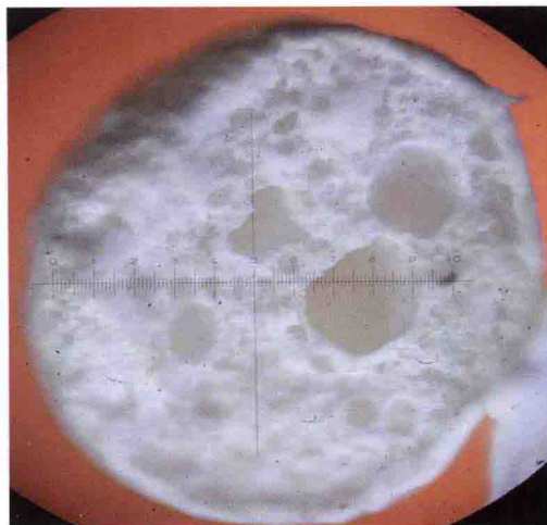
图 5-13 典型的内部孔隙分布不均匀的药粒切片观察图
