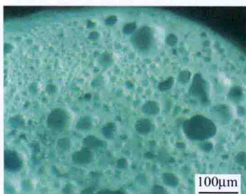
图 5-12 驱溶阶段球形药颗粒内部孔隙显微镜观察图
