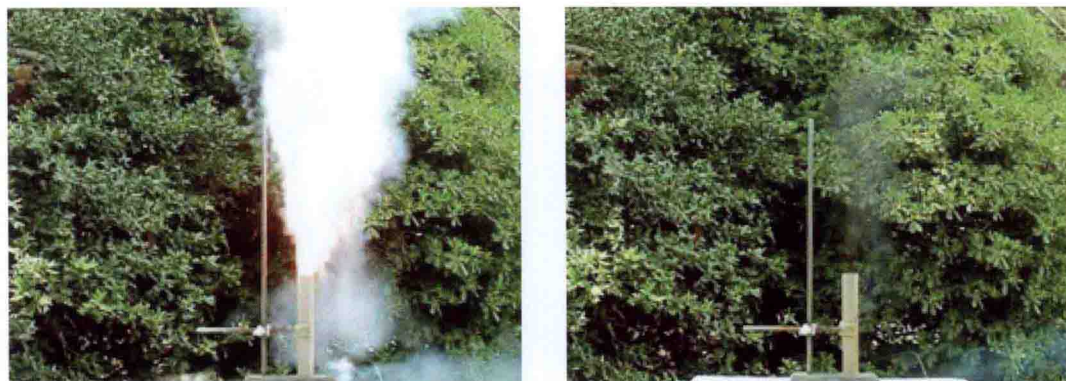
图 5-26 黑火药与无烟药装药发射烟雾状况对比
