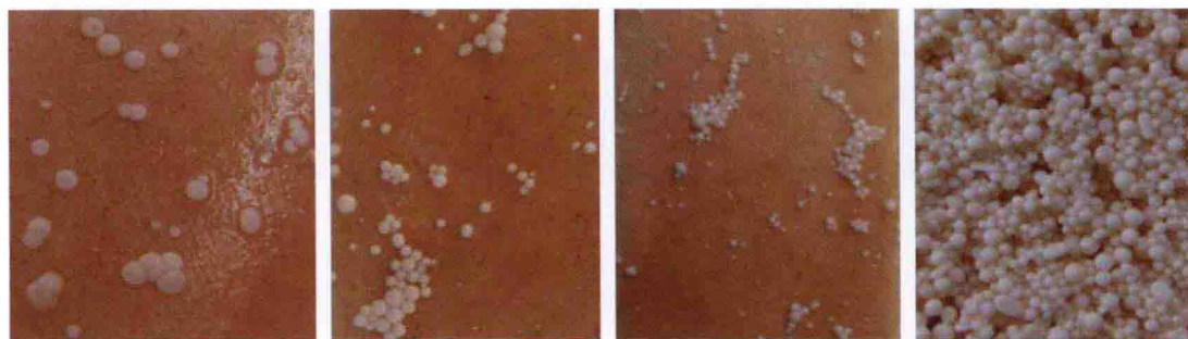
图 4-3 双基球形药成型过程中有机相物料形态变化观察图
