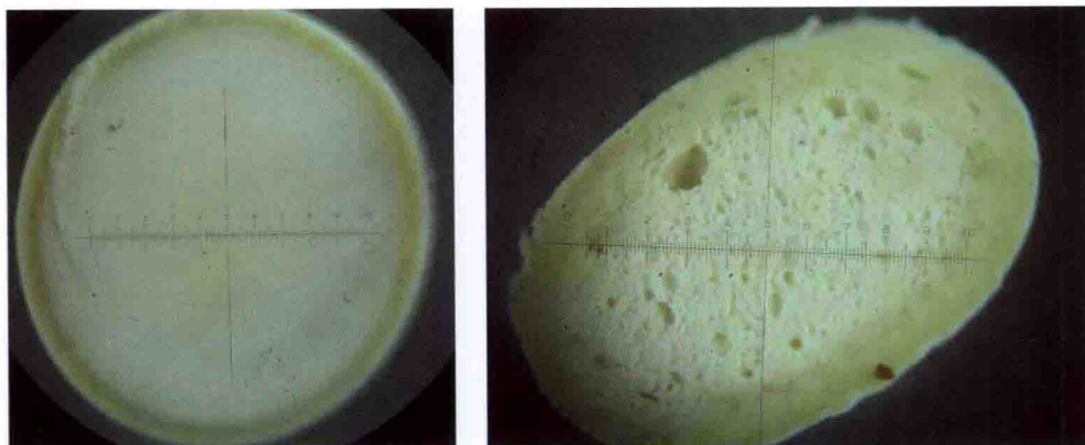
图 5-46 一步法制备的典型分层微孔药的切片显微观察图
