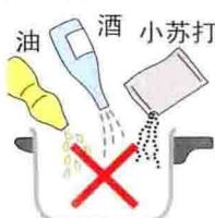
小苏打一经加热会急速发泡，酒一经加热会产生酒精，油经过高温，容易堵塞蒸汽排出口，进而发生危险。因此，绝对不允许放入大量的小苏打、油和酒。
