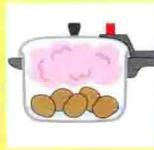
熄火后压力逐渐下降。压力下降，浮子落下。
