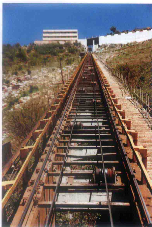
会泽铅锌矿麒麟厂矿区全长520米、坡度为34度27分的双绳运矿斜坡道
