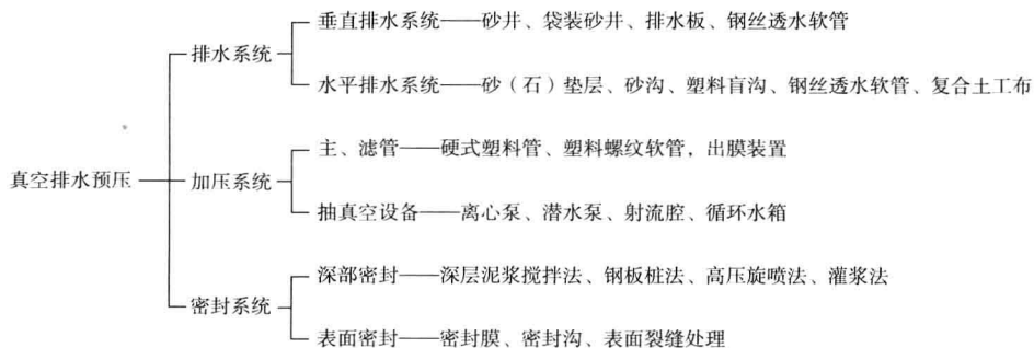
图 1-2 真空排水预压加固软土的三个系统
