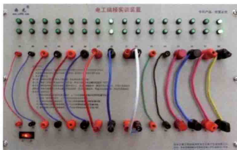
图3-23 电工端接实训装置
