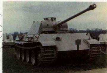
德军在莫斯科保卫战首次受挫后，为了改变己方坦克与苏联T-34交战的不利局面，研制出新型的能与T-34相抗的坦克已势在必行。1941年，德国的MAN、亨舍尔等公司接受军方研制新型坦克的委托后，以原有的四号坦克为基础，借鉴T-34坦克的外形制造出样车，型号为VK3001，其中MAN公司在德军原来的四号坦克基础上，加装了75毫米口径加农炮，借鉴T-34改进外形，得到德国军方的充分肯定，这就是后来威名远扬的豹式坦克。1942年5月德国军方最终采用了MAN公司的设计，并于同年12月正式投产，在1943年以后，开始由戴姆勒-奔驰公司、MAH公司、亨舍尔公司分担生产。
