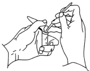
图 0-2 用倾泻法将沉淀 和溶液分离
