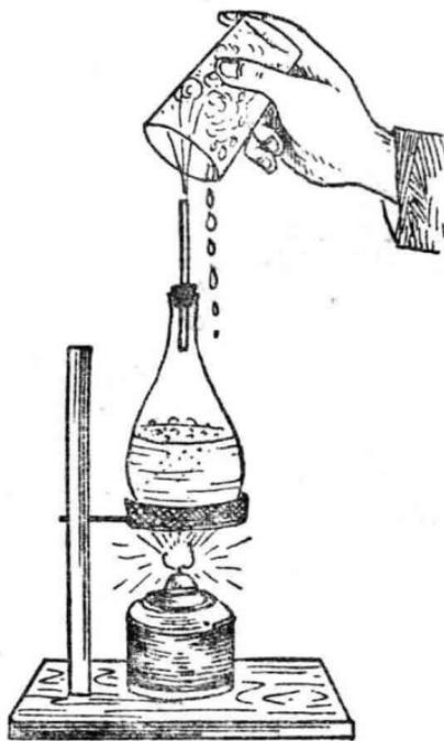
圖，裝置既畢，然後在燈上點火，把水煮了一會，再用一隻玻璃杯，罩在管上，使水蒸氣完全噴入杯中，就見牠碰着冷玻璃杯以後，會變做一滴一滴的水點，從杯中落下
