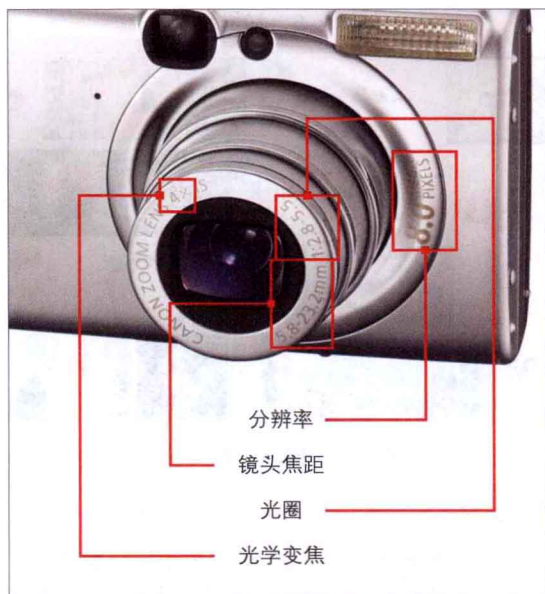
图1-9 数码相机的主要硬件标志
