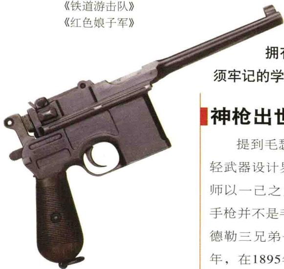
7.63 × 25毫米毛瑟手枪弹。毛瑟军用手枪采用枪管短后坐式自动原理，闭锁方式为闭锁卡铁起落式，弹匣供弹，枪管内刻有6条右旋膛线，并首次采用了空仓挂机机构。这些结构原理的发明，使得毛瑟军用手枪比同时期的其他手枪性能更为优越。
