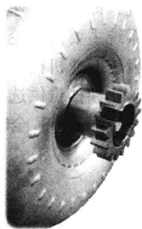
图 1-9 液力变矩器与油泵的连接
