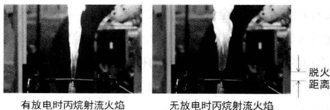
图2 钨针高压纳秒脉冲放电等离子体点火助燃(燃料为丙烷)实验照片
