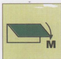
外部通风进口或出口的 关闭装置(机器处所) Closing Device for Ventilation Inlet or Outlet for machinery Spaces
