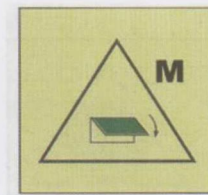
外部通风进口和出 口关闭装置的遥控 机构(机器处所) Remote Control for Closing Devices for Ventilation Inlet and Outlet for machinery Spaces
