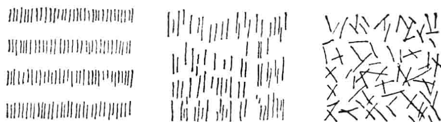
(a)晶体 (b)各向异性的向列液晶 (c)各向同性的液体
