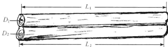
L_1, L_2 ——材长 D_1, D_2 ——直径 图8 原木干身连在一起的尺寸量法
