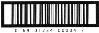
图2 表示13位数字代码的ITF-14条码示例
