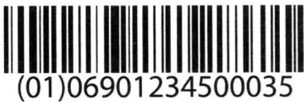
图3 表示13位数字代码的GS1-128条码示例
