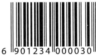
图1 表示13位数字代码的EAN-13条码示例
