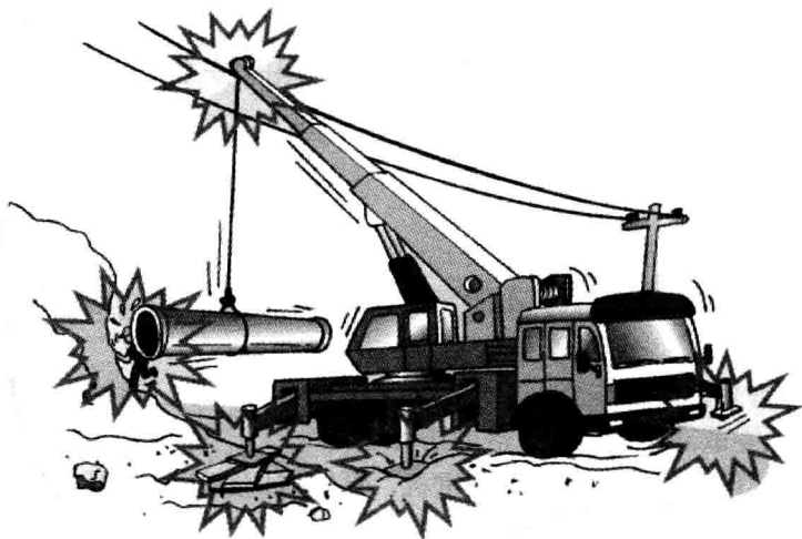
图 2-6 地基条件、地面障碍物与架空高压线等综合环境的影响
