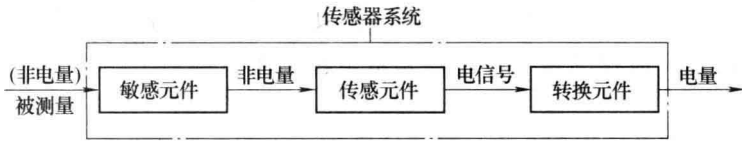
图 2-2 传感器的结构图（从系统角度）
