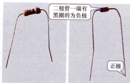
图 1-3 对电阻及二极管进行整形
