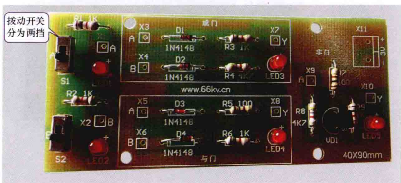
图 1-7 焊接拨动开关
