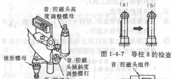
图 1-4-6 音/控磁头组件
