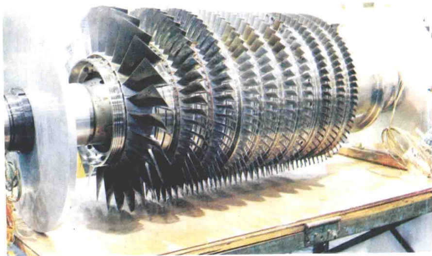
P & W 公司高效节能 发动机高压压气机 转子组件
