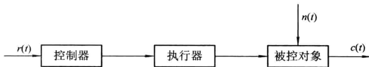
图 1-4 按给定值操纵的开环控制系统原理方框图
