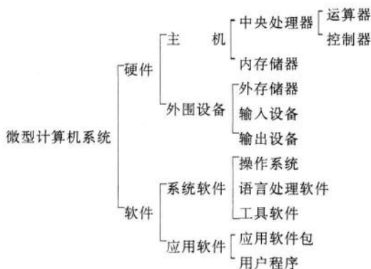
图 1—1 微型计算机系统的组成
