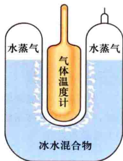
图 9-5 水的三相点,即冰、水、水蒸气同时存在且达到平衡状态时的热力学温度定义为 273.16\text{K}
