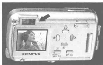
图2.5 保留旁轴光学取景器的数字相机
