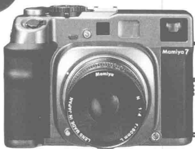
图2.3 单镜头平视取景照相机
