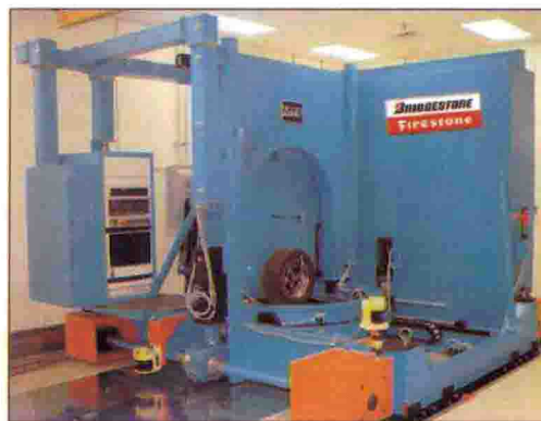
图 7.15 由 MTS 和普利司通/凡士通联合制造的现代移动框架、固定床身和平带试验机
