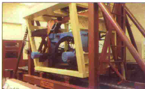
图 7.14 Smithers Scientific Services 公司安装的固定框架、移动床身和平带试验机 [14]
