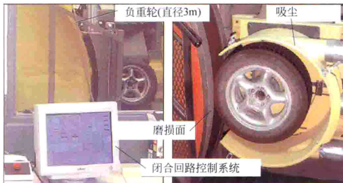
图 7.62 室内磨损试验设备的特点 [30]
