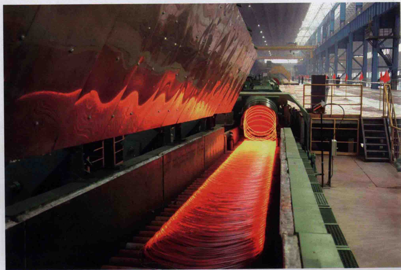
首钢国际工程公司设计的首钢一线材轧机关键设备国产化
