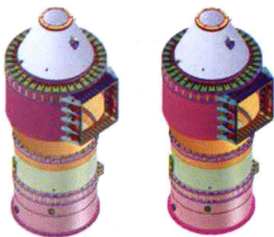
干熄焦系统干熄槽三维设计
